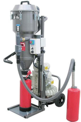
Les machines à poudre permettent de vider les extincteurs à poudre, de les remplir et de tamiser la poudre. Robustes et ergonomiques ces machines offrent le meilleur de la qualité actuellement disponible. Elles sont facilement transportables. La hauteur de travail s'adapte selon les besoins. Conforme aux normes EN 292 et EN 60204.
