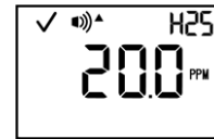
Seuil d'alarme haute
